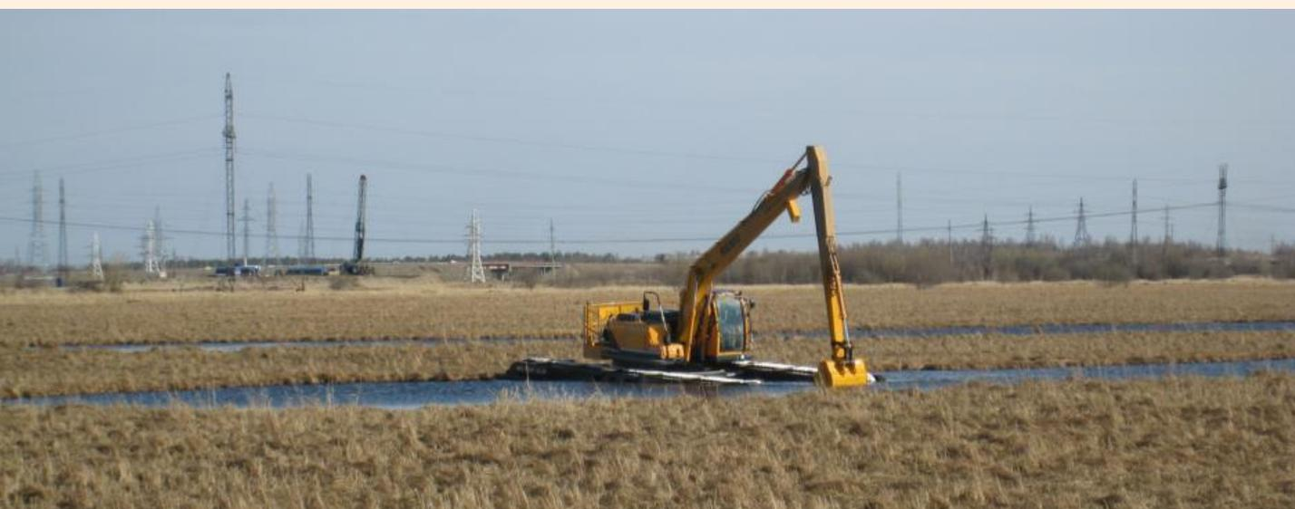
Внесезонный подход с применением зимней рекультивации позволяет ежегодно наращивать темпы восстановления земель. Для реализации комплексного подхода используются самые современные спецмашины - экскаваторы-амфибии, крупнотоннажные вездеходы, плавающие болотоходы, снегоходы, мини-вездеходы.
